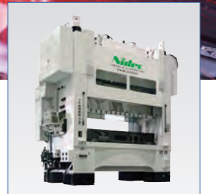
モータコア加工用 精密高速自動プレス機
