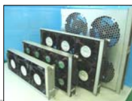
Router fan tray
