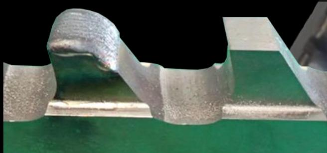
摩耗した刃部の補修、安価な母材に刃部のみ造形などでコスト削減
