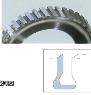
ダブルテーブルブローチ加工溝形状
