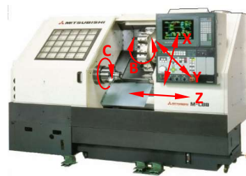
複合車床的直線軸和回轉軸
