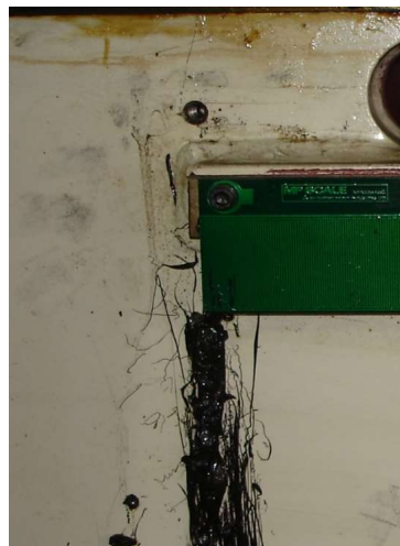
使用7年的直尺實例 即便大量附著鑄造物的切粉和油也 正常運作中
