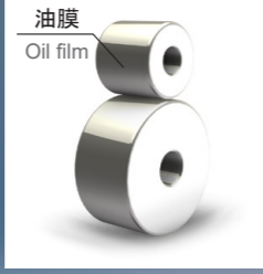
油膜 Oil film トラクションドライブ Traction Drive
