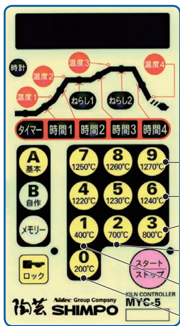
ニデックドライブテクノロジーのマイコン 陶芸専用マイコンMYC-5
