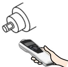
レーザー光の照射口を、回転体に貼り付けた反射テープに向けます。
