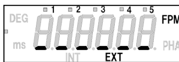
外部入力パルスの周波数が27fpmを下回る場合 アンダーマーク表示
