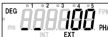
外部入力パルスの周波数が27fpmを下回る場合 数値桁以外にアンダーマーク表示
