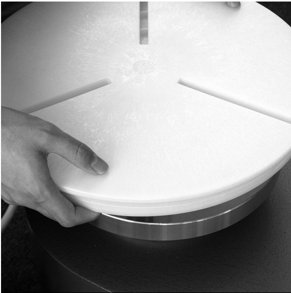
⑪ 上面テーブルを取付けた下面テーブルをろくろのターンテーブルにはめ込みます。
