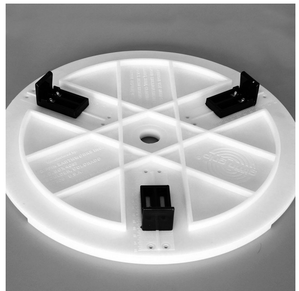
⑧ 下面テーブルが動く場合は、目盛りを3ヶ所とも1または2狭くしてください。はめ込めない場合は目盛りを3ヶ所とも1または2広くして取付ブラケットを取付けます。
