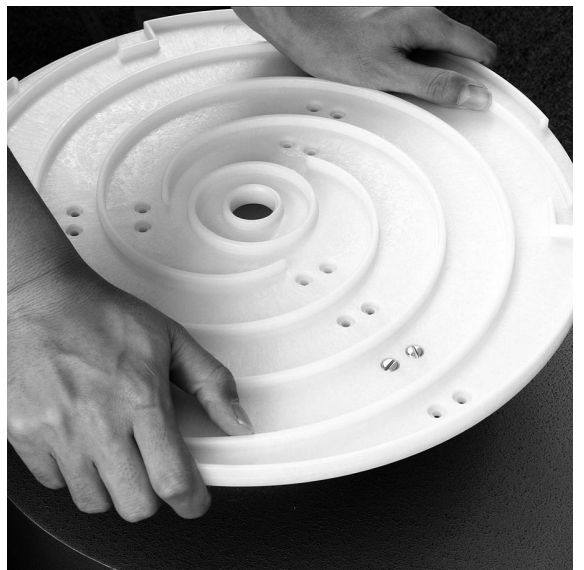
⑥ ろくろのターンテーブルに下面テーブルをはめ込みます。
