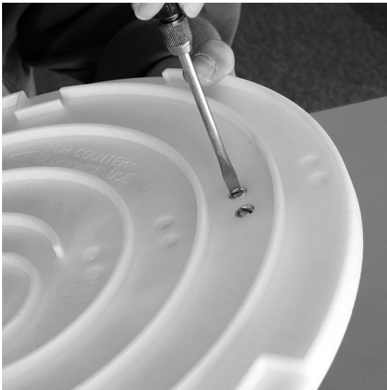
③ 取付ブラケットを付属のボルト、ナットで固定します。
