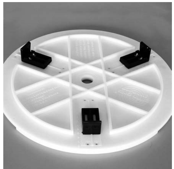
⑧ 下面テーブルが動く場合は、目盛りを3ヶ所とも1または2狭くしてください。はめ込めない場合は目盛りを3ヶ所とも1または2広くして取付ブラケットを取付けます。
