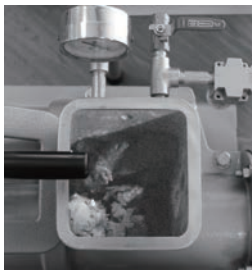
▲ 粘土が真空室へ上がってきている状態 (スクリューも確認できません)
