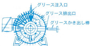
図2 グリース排出口 (脚取付形の例)
