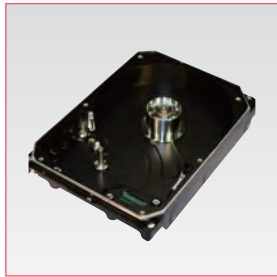
硬盘驱动器（HDD）用电机与底座
