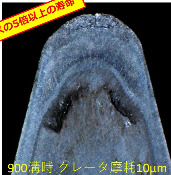
900溝時 クレータ摩耗10 $\mu$ m
