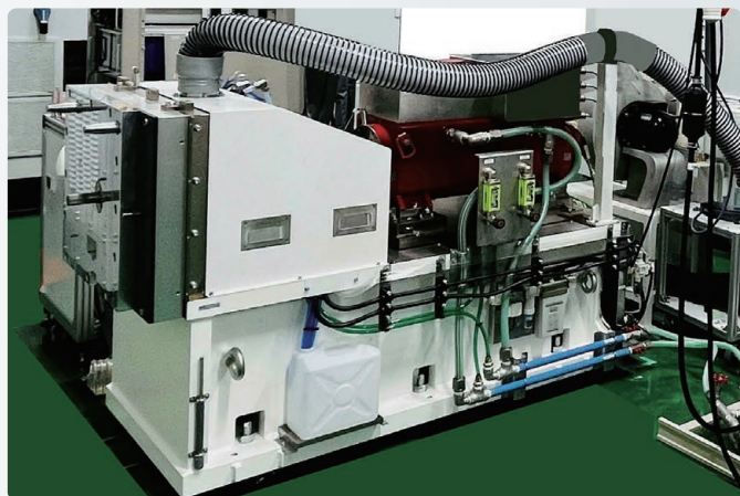
● システム構成例：EVモータ用1軸テストベンチ (20,000rpm仕様) System configuration example: 1 axis Test Bench for EV Motor (20,000rpm)
