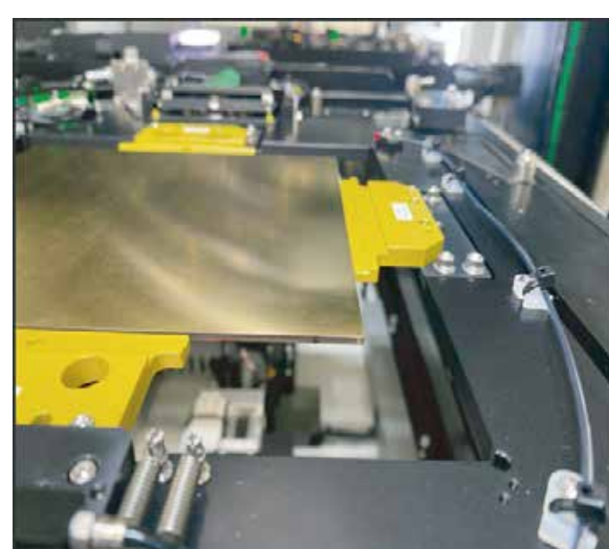
▲ 1シャトル1枚搬送時のイメージ The image above shows 1pc transport per shuttle
