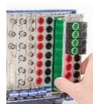
測定カード 実装方式
