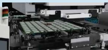
这是用于半导体封装载板的电性检测设备。除了OPEN/SHORT/LEAK测试外，还支持LCR和嵌入式IC等各种封装载板的测试，是拥有丰富经验的行业标准设备。
