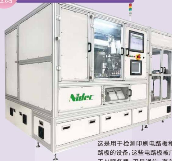
这是用于检测印刷电路板和柔性电路板的设备，这些电路板被广泛应用于AI服务器、卫星通信、汽车车载部件等多种用途。设备能够灵活应对检测工件的种类、尺寸以及检测针数。
