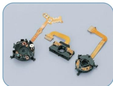
■手振れ補正機構
