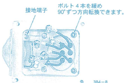
図6 導線引き込み口の方向転換
