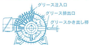
図1 グリース排出口（脚取付形の例）
