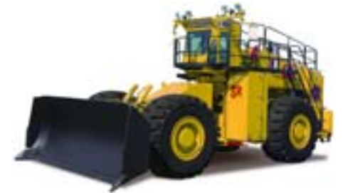
SRモーターが搭載されているショベルカー
