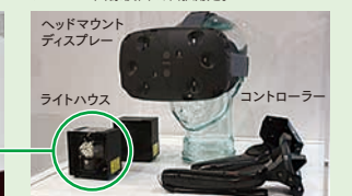
▲VRのキット(ライトハウス(LIDAR装置)内に当社のFDBモータを使用)
