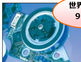
光ディスク装置用モータ
