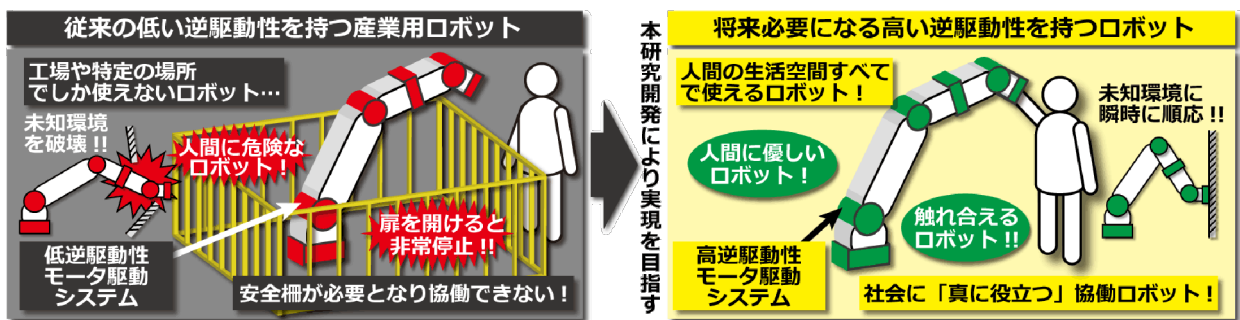
図1 従来の産業用ロボットの問題点と将来必要となる社会に「真に役立つ」協働ロボット
