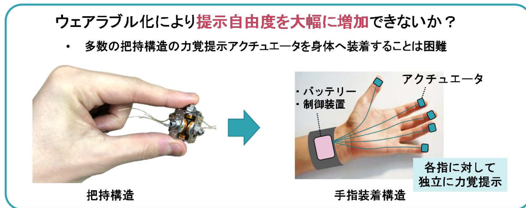
図 7 提示自由度の拡張を目指した構造検討
