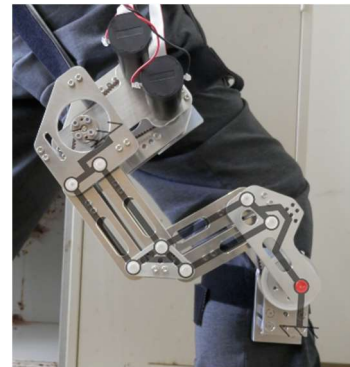
図 5. 設計した角度差をもつ 2 つの平行リンク機構と遠隔駆動用ベルト経路をもつ膝装具機構。
