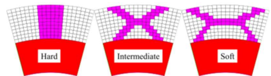
図 2 トポロジー最適化手法から想起される可変磁気ばね剛性
