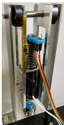
図 3 ソレノイドアクチュエータを用いたばね振り子型の簡易試験機
