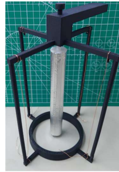
図 2 試作した 2 自由度回転機構
