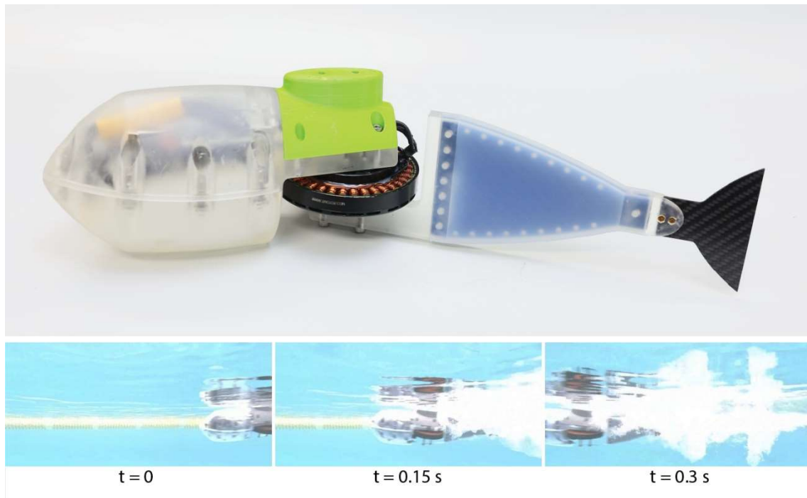
図 1. 高速化したロボット(全長 415 mm, 上段)とその遊泳の様子(下段)。
