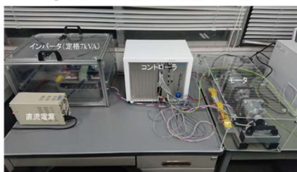
(e) 助成金で導入したモータ駆動システム。インバータのスイッチングに基づきモータを制御。インバータ周りの電流や電圧を計測可能。
