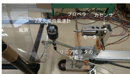
(a) 風速と外力を調整可能なプロペラ推力制御系。風速とプロペラ角速度に応じて制御器を調整することで高精度な推力制御を達成。
