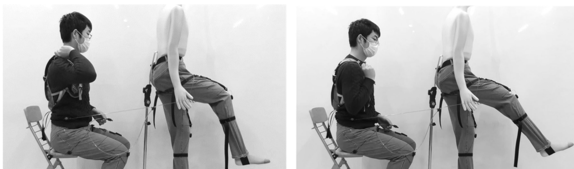
(a) 駆動側人工筋を伸長する前 (b) 駆動側人工筋を伸長した後
