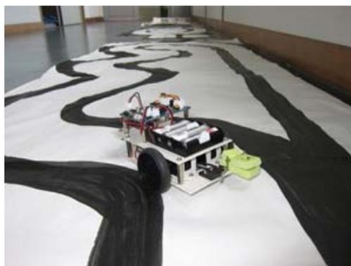
光が反射する白色と反射しない黒色で構成されたサーキットで車を走らせると、車は黒色のエリアには進入せず、白色のエリアだけを進むので、あたかも人が操縦して道なりに走らせているかのように見えるのです。
