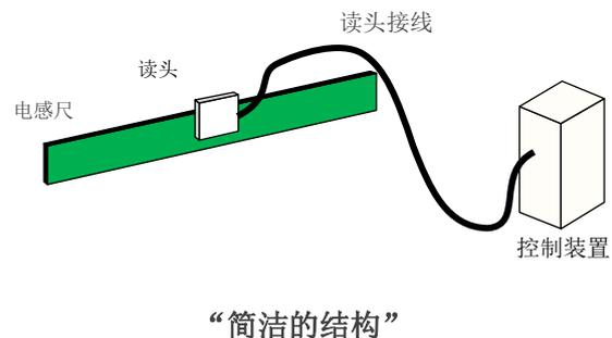
MPLS 系列是检测直线轴位置的分辨率<sup>\*1</sup>为  $0.05 \mu\text{m}$ 、间距精度<sup>\*2</sup>为  $10 \mu\text{m}$  的高性能电感尺。在传统的 MPLN 系列中，是将电感尺和读数头均安装在目标机器上，由控制装置从二者发送和接收电信号，但此次我们研发出了从电感尺不受干扰地接收其发出信号的检测格栅<sup>\*3</sup>，这种信号检测方式不再需要电感尺接线。此外，由于读数头内置了能够将来自电感尺的电信号转换为数字信号的 A/D 转换器功能，因此只需电感尺和读数头就可以与机器的控制装置进行信号的发送和接收。随着这些技术的进步，我们不再需要电感尺接线与 A/D 转换器，并且减少了零部件数量与制造工艺，从而降低了价格、缩短了交货时间，使安装变得更加简单。
