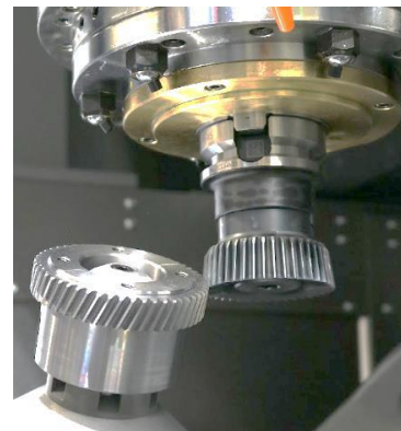
齿轮加工示例：工件（左）、刀具（右）
