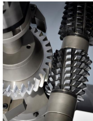
【歯車(左)と専用面取工具 ChamferX(右)】
